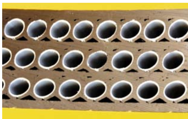
Розріз труб на стінці профілю SQ
