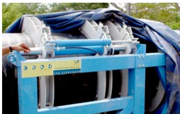
Стикове зварювання труби Krah
