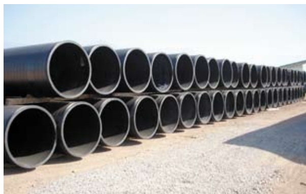
Приклад типового зберігання труб
